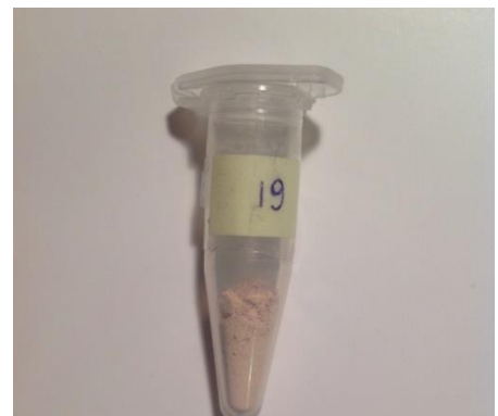
Рисунок 18: смешанные оксалаты Ce_2(C_2O_4)_3 \cdot 10H_2O и ZrOC_2O_4 , 92 мол %
