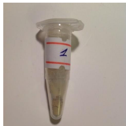
Рисунок 6: соосажденные оксалаты ZrOC_2O_4 и Pr_2(C_2O_4)_2 , 10 мол %
