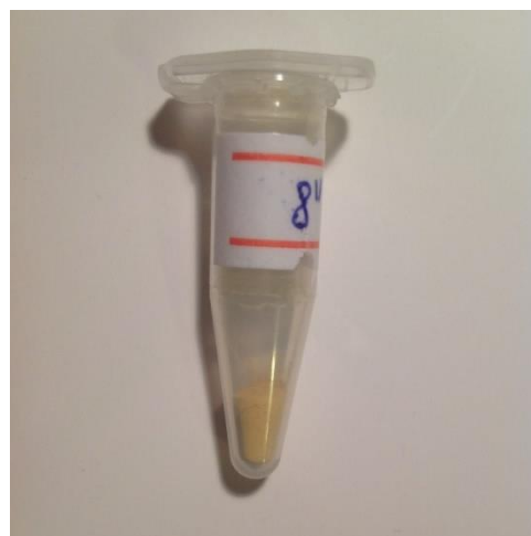
Рисунок 8: соосажденные гидроксиды \text{ZrO}(\text{OH})_2 и \text{Pr}(\text{OH})_3 , 10 мол %, 1200С
