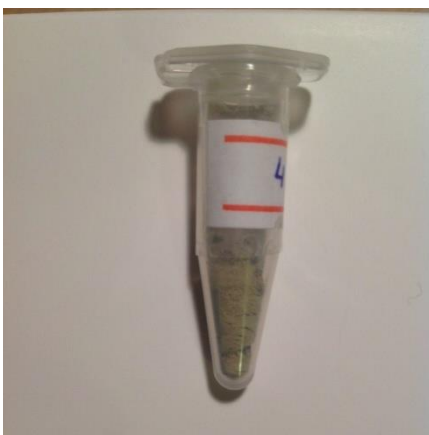
Рисунок 3: смешанные оксалаты ZrOC_2O_4 и Pr_2(C_2O_4)_2 , 5 мол %
