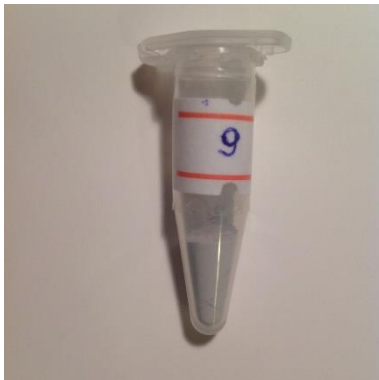
Рисунок 10: смешанные оксалаты ZrOC_2O_4 и Nd_2(C_2O_4)_3 , 10 мол %
