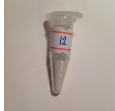
Рисунок 12: смешанные оксалаты ZrOC_2O_4 и Nd_2(C_2O_4)_3 , 5 мол %
