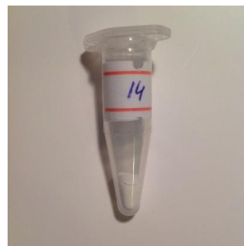
Рисунок 15: соосажденные гидроксиды ZrO(OH)_2 и Y(OH)_3 , 10 мол %
