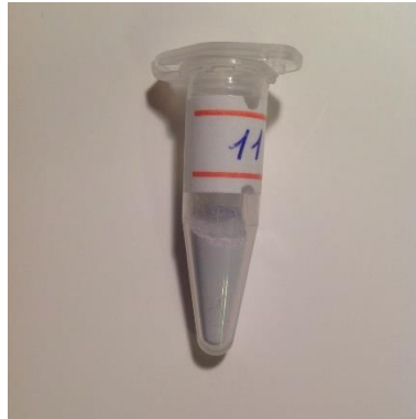
Рисунок 11: смешанные оксалаты ZrOC_2O_4 и Nd_2(C_2O_4)_3 , 30 мол %
