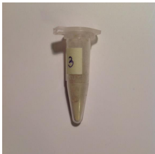
Рисунок 9: смешанные гидроксиды \text{ZrO}(\text{OH})_2 и \text{Pr}(\text{OH})_3 , 10 мол %.
