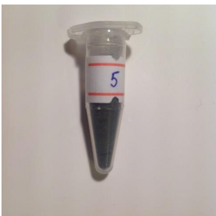
Рисунок 4: смешанные оксалаты ZrOC_2O_4 и Pr_2(C_2O_4)_2 , 30 мол %
