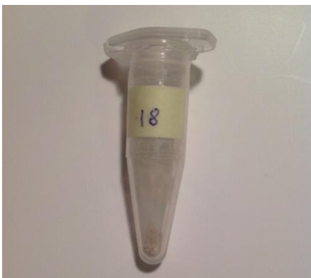
Рисунок 17: соосажденные гидроксиды Ce(OH)_3 и ZrO(OH)_2 , 92 мол %
