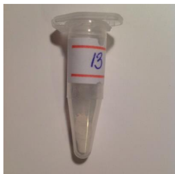
Рисунок 14: соосажденные гидроксиды ZrO(OH)_2 и Y(OH)_3 , 5 мол %
