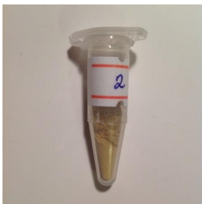
Рисунок 2: смешанные оксалаты ZrOC_2O_4 и Pr_2(C_2O_4)_2 , 10 мол % стабилизатора
