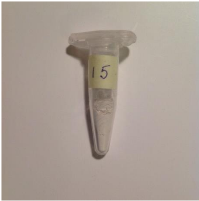
Рисунок 16: смешанные оксалаты ZrOC_2O_4 и Y_2(C_2O_4)_3 , 10 мол %
