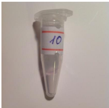
Рисунок 13: соосажденные гидроксиды ZrO(OH)_2 и Nd(OH)_3 , 10 мол %
